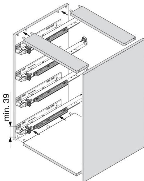
Si les coulisses doivent être mises en place avant l'assemblage du corps de meuble, la position de fixation doit être augmentée au minimum (soit : de 1 mm de 38 à 39 mm) en raison des tolérances pour la coulisse et le corps de meuble !
