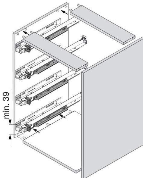
Si les coulisses doivent être mises en place avant l'assemblage du corps de meuble, la position de fixation doit être augmentée au minimum (soit : de 1 mm de 38 à 39 mm) en raison des tolérances pour la coulisse et le corps de meuble !
